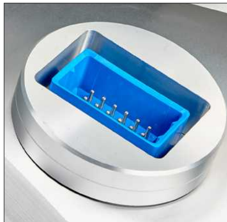
In der Stütze vorn rechts befindet sich versenkt die Kontaktbrücke zwischen Netzteil und Amp.
