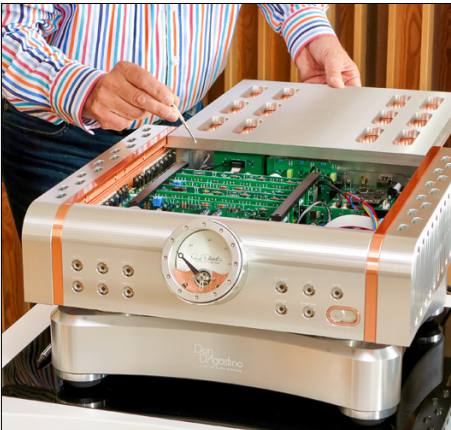
Zur Anpassung der Phono-MC-Impedanz muss der Gehäusedeckel herausgezogen werden.
